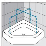
Rilevare le misure da muro a bordo interno del piatto doccia. Le misure devono essere rilevate sulla parete finita, a rivestimenti posati, secondo gli schemi riportati.
